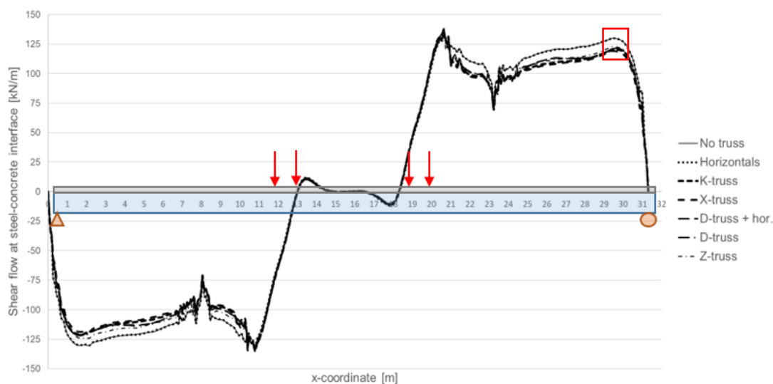
Figur 11. Skjuvflödet längs med bron i den mest belastade balken då lasten står centriskt på bron.
